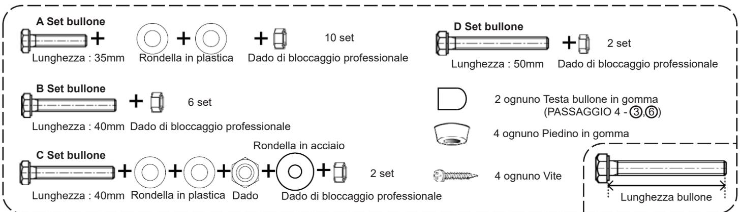
\* Durante l'assemblaggio si prega di fare attenzioni alle superfici affilate, come per esempio i lati della piastra a croce. Per l'assemblaggio è necessario un cacciavite e chiavi inglesi 10mm (13/32").
