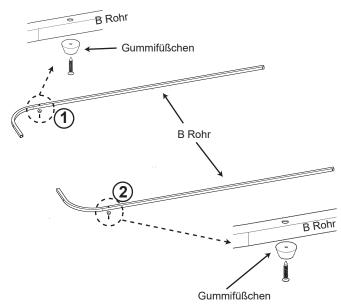
(1),(2) Schrauben Sie das Gummifüßchen in das A Rohr.
