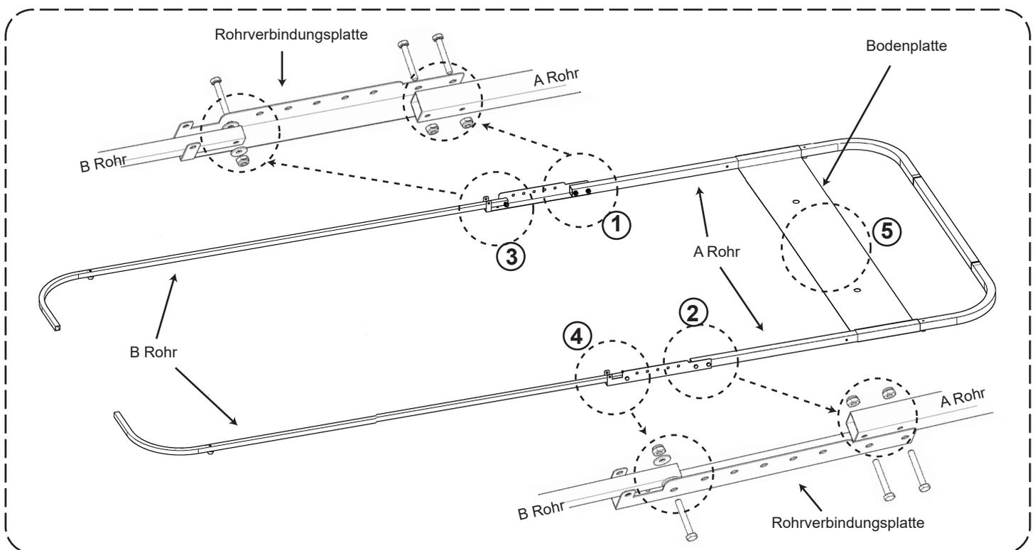
\* Alle Schrauben The Bike Shield sollten von außen nach innen eingesetzt werden.
